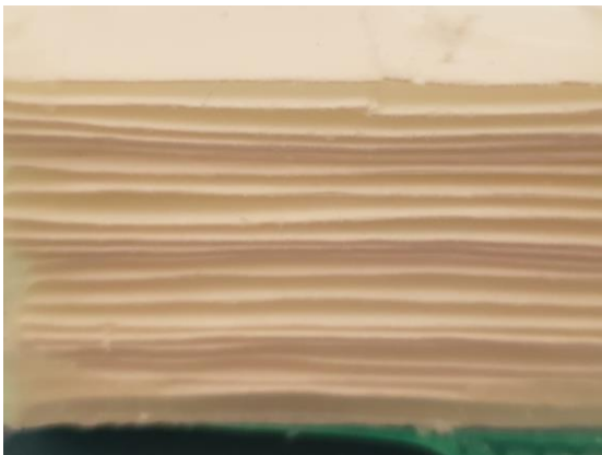
Figura 4. Foto de uma membrana hidrofóbica plissada de filtro mecânico
